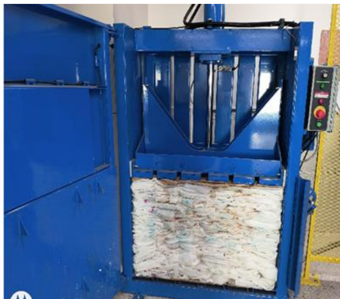
Presse de compactage contribuant à la réduction du volume de déchets et à l'optimisation des pratiques de gestion des matières résiduelles
